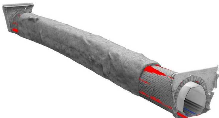
Obr. 3 Průkaz prostorové průchodnosti na 3D modelu (Ždárský tunel)
